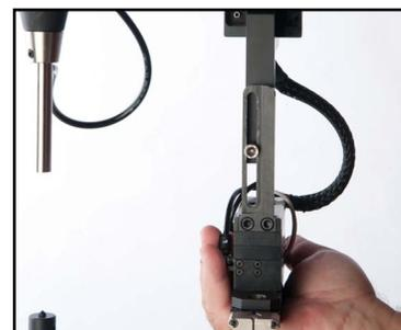
Nuevo soporte en T y lanzadera con controles integrados.
