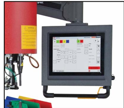
Unidad de control del operador ajustable en 6 direcciones.
