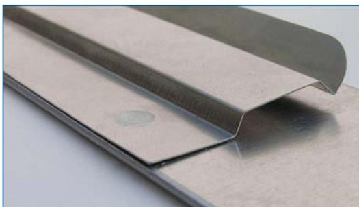
.005" / 0.13 mm 以上の薄い母材を、PEM® スポットファースト® ファスナーを用いて厚い母材に取り付けられます。薄い母材を panel 1 とし、ファスナー全長 L が母材の合計板厚以下になる必要があります。さらに詳しい情報については、弊社アプリケーションエンジニアリング部門にご相談ください。
